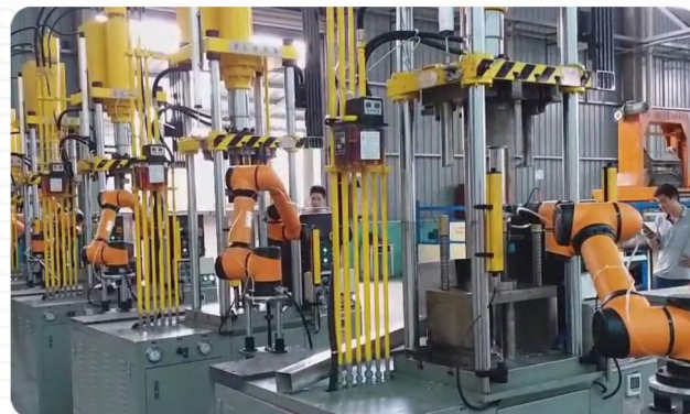
AUBO-i5 油压机拉伸线上下料应用
